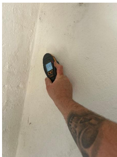
Fuktgenomslag missfärgning på yttervägg i tvättstugan. Delvis med högre och höga fuktvärden. 16,8% och 99,9%.
