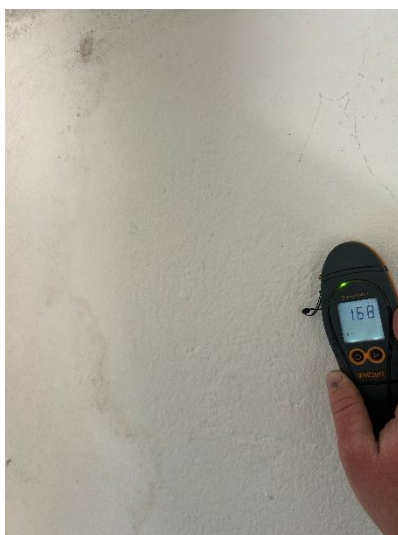
Fuktgenomslag missfärgning på yttervägg i tvättstugan. Delvis med högre och höga fuktvärden. 16,8% och 99,9%.
